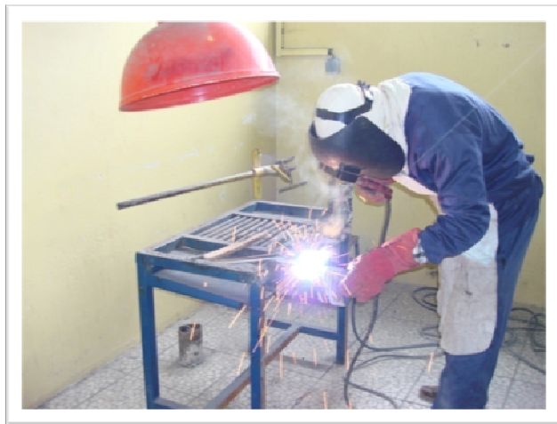
اجرای جوش E8 داخل کابین توسط کارآموز
