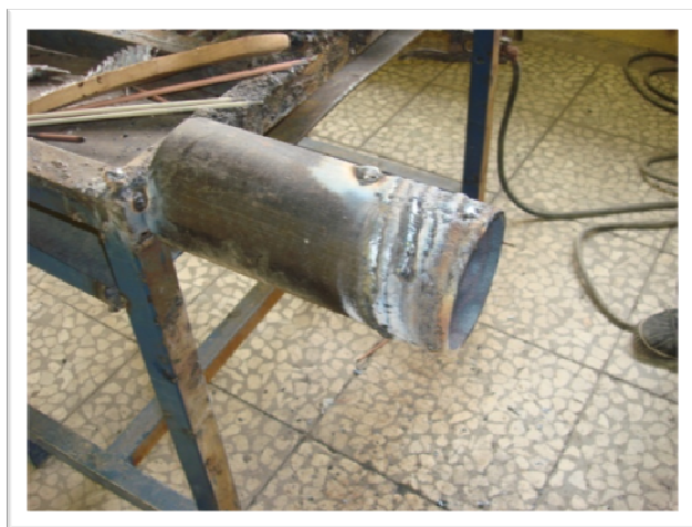
اجرای جوش برق (E8) دور لوله توسط کارآموز
