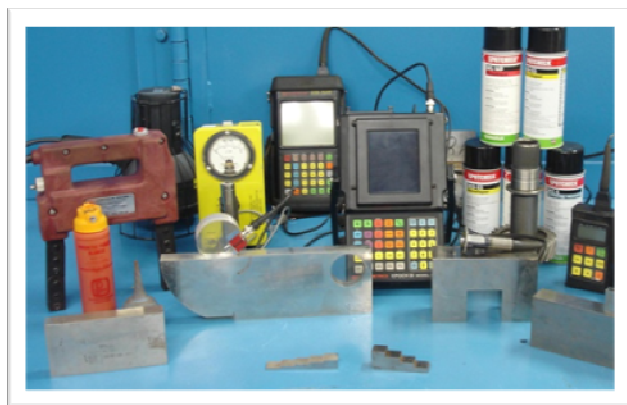
تجهیزات آزمایش MT
